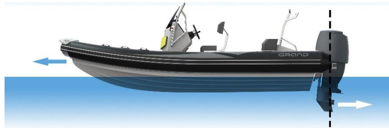
Fig. 22. Optimum trim/motor angle.
