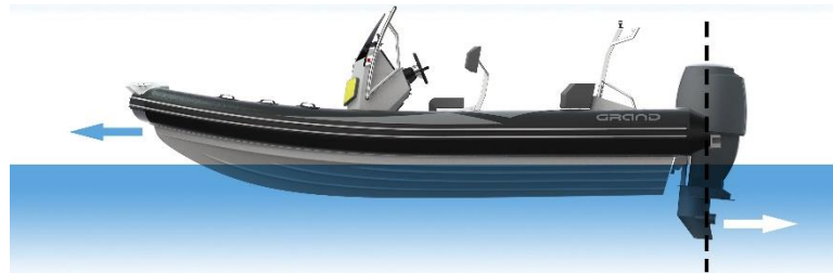
Fig. 22. Optimum trim/motor angle.
