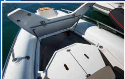
Amortizeri olakšavaju pristup spremniku
